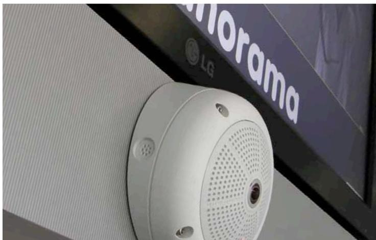
Настенная установка с помощью держателя с 10° наклоном
